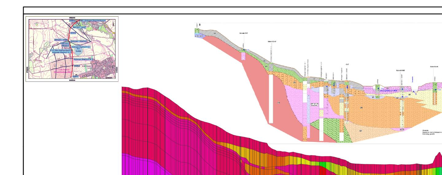
Legende 2,0e-3 - 2,5e-3 1,5e-3 - 2,0e-3 1,0e-3 - 1,5e-3 5,0e-5 - 1,0e-4 1,0e-5 - 5,0e-5 5,0e-6 - 1,0e-5 FEFLOW-Schnitt 3-3' Horizontale kf-Werte (m/s) 4,5e-3 - 5,0e-3 7,5e-4 - 1,0e-3 1,0e-6 - 5,0e-6 4,0e-3 - 4,5e-3 5,0e-4 - 7,5e-4 1,0e-7 - 1,0e-6 3,5e-3 - 4,0e-3 2,5e-4 - 5,0e-4 1,0e-8 - 1,0e-7 3,0e-3 - 3,5e-3 1,0e-4 - 2,5e-4 < 1,0e-8 2,5e-3 - 3,0e-3
