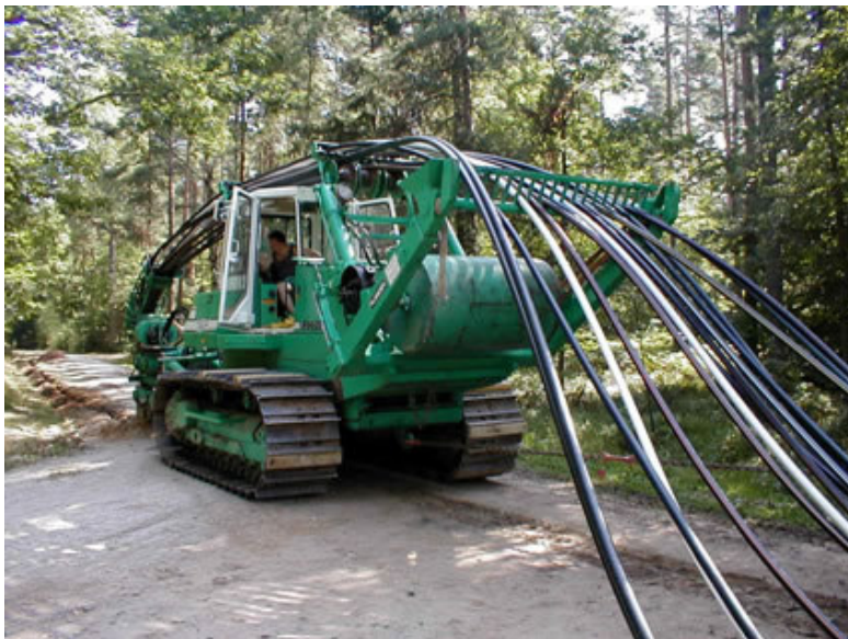
Abb. 1: Beispiel Kabelpflug (Quelle: www.heinz-bente.de )
