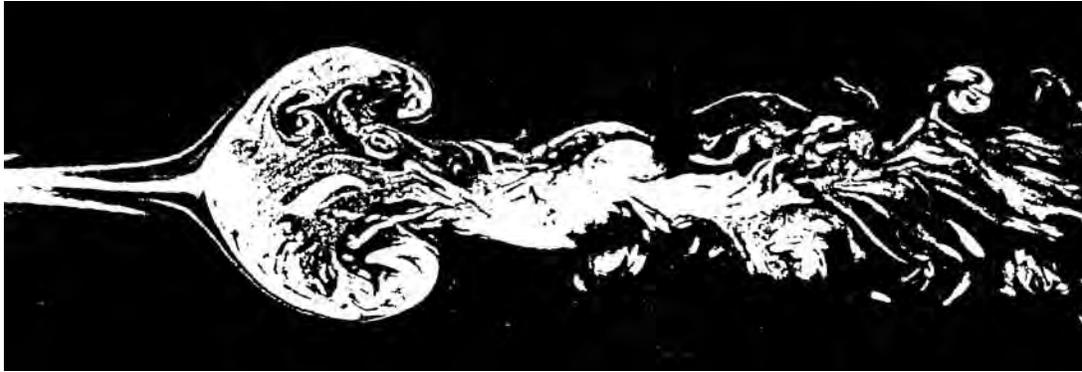
Bild 7.4: Beispiel für das Wirbelaufplatzen (vortex breakdown) einer drallbehafteten Strahlflamme in einem zylindrischen Rohr
