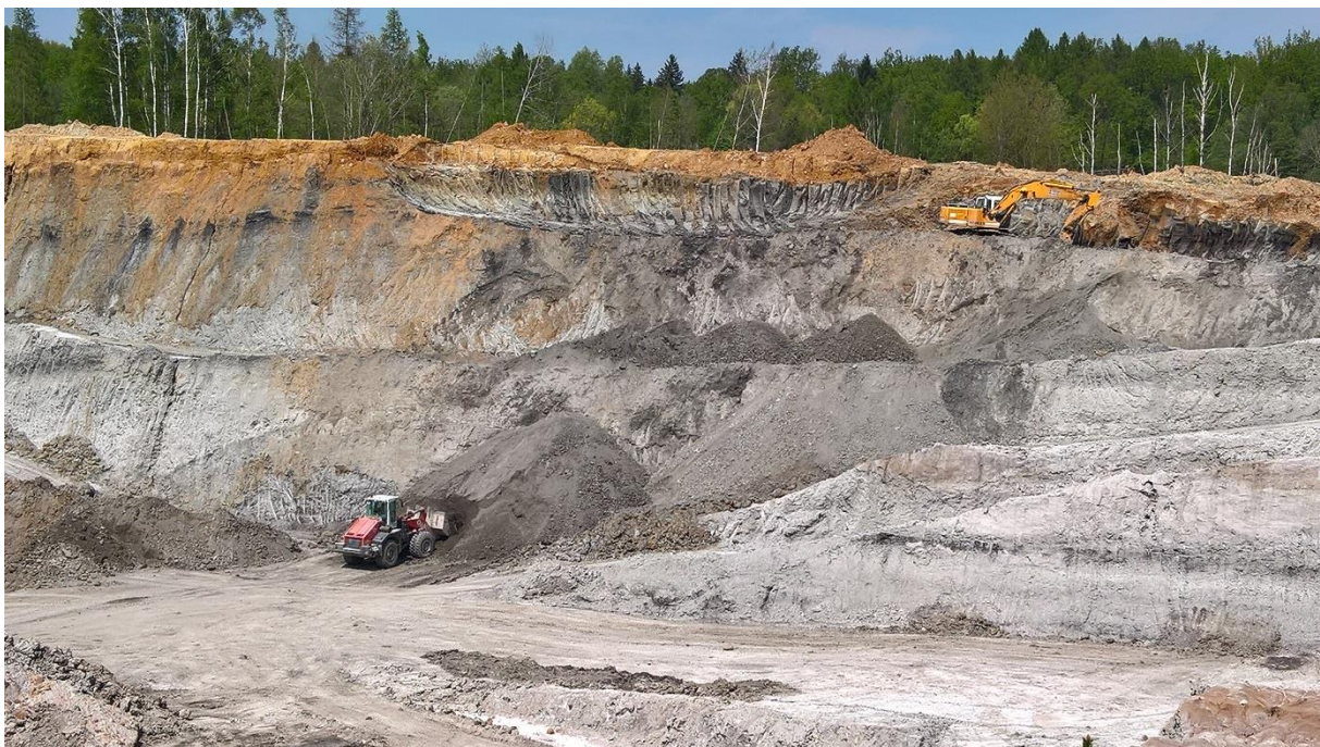
Abb. 5.2.4: Gewinnung von Wealden-Tonstein im Hils, der vor allem in der Umwelttechnik als Dichtungston eingesetzt wird.
