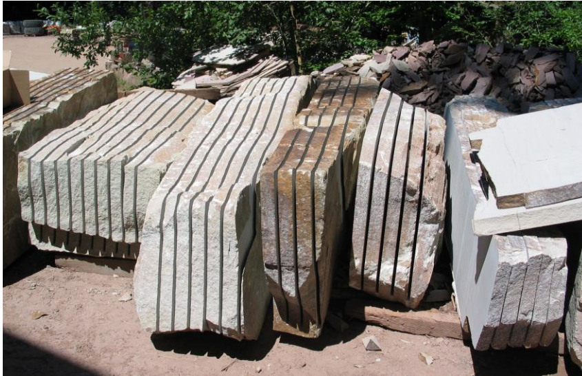
Abb. 5.6.4: Gesägter Wesersandstein (Solling-Formation, Mittlerer Buntsandstein) der Trias aus dem Raum Karlshafen.
