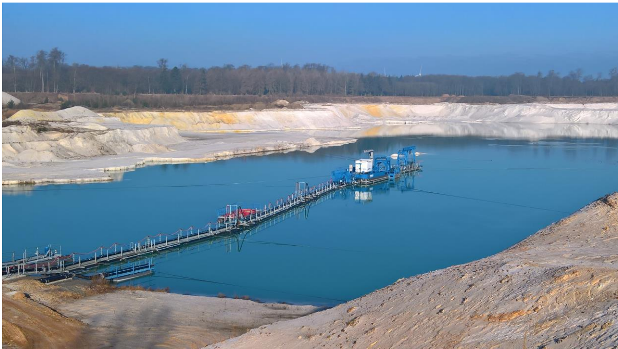
Abb. 5.1.15: Gewinnung von hellen, eisenarmen Quarzsanden bei Uhry, Landkreis Helmstedt.
