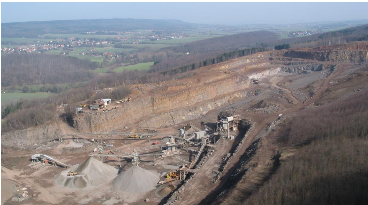
Abb. 5.3.4: Kalkstein-Abbau im Landkreis Schaumburg zur Produktion von Gesteinskörnungen für den Verkehrswegebau.
