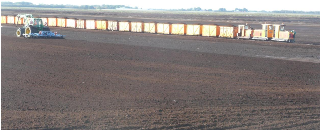
Abb. 5.9.2: Torfabbau im Fräsverfahren (Dalum-Wietmarscher Moor). Lockerung der Torfe mit einem Grubber und Transport mit der Moorbahn. Im Vordergrund eine rekultivierte Abbaufäche.
