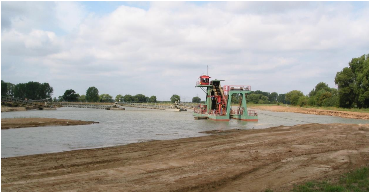
Abb. 5.1.6: Nassabbau von Kies mittels Eimerkettenbagger und Bandstraße im Landkreis Nienburg.
