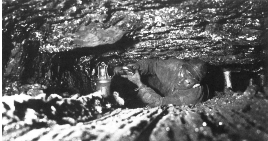
Abb. 7.11: Bergmann im nur 40 cm hohem Streb (Bereich, in dem Kohle abgebaut wird) beim Abbau von Wealdenkohle im Wiehengebirgsvorland (Foto: K.-R. Haarmann).
