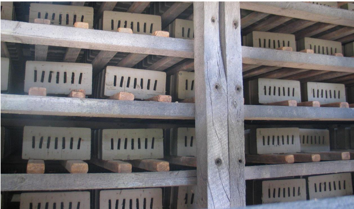
Abb. 5.2.9: Auch heute noch werden die Klinkerrohlinge einzeln im Hofmannschen Ringofen aufgestapelt und nach dem 14-tägigen Brennvorgang manuell wieder dem Ringofen als original Wittmunder Klinker entnommen. Diese traditionsreiche Produktionsmethode lässt sich nur durch ein genaues Auge und die exakte Bemessung der Torfbefuerung per Hand steuern.
