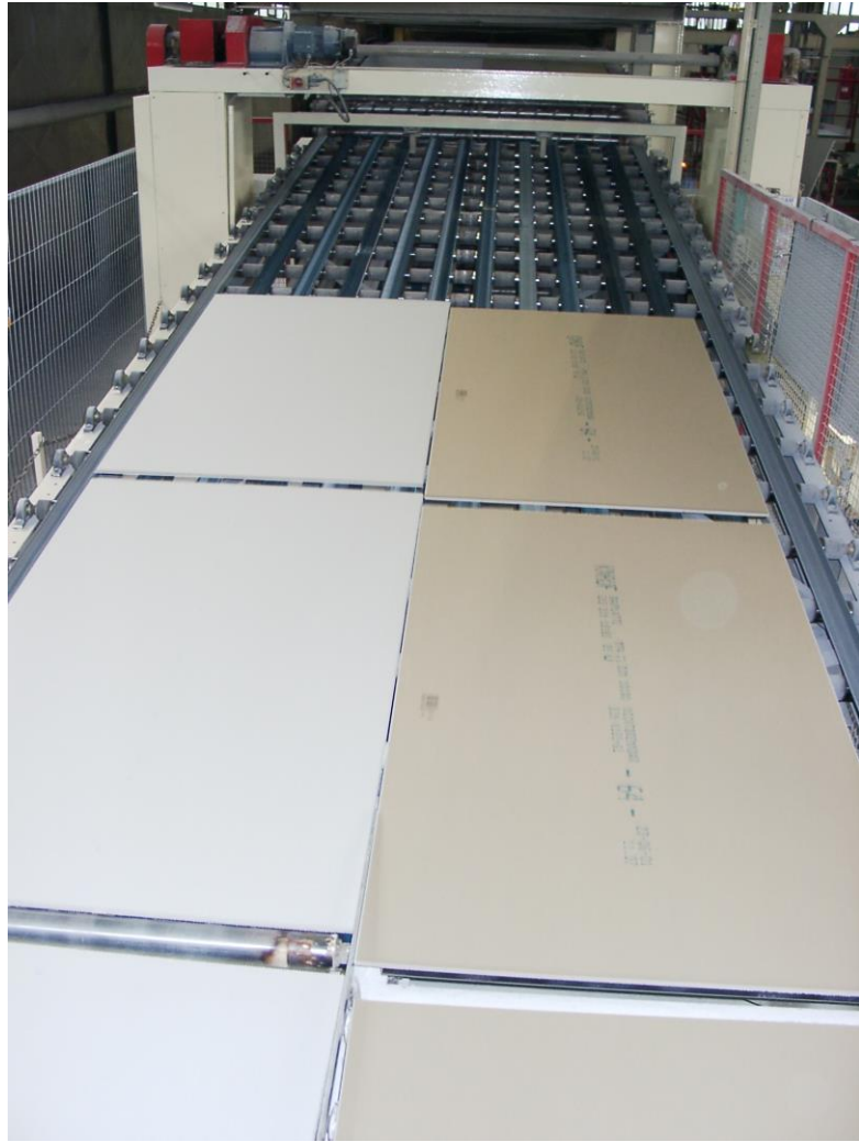
Abb. 5.5.3: Fließbandproduktion von Gipskartonplatten.
