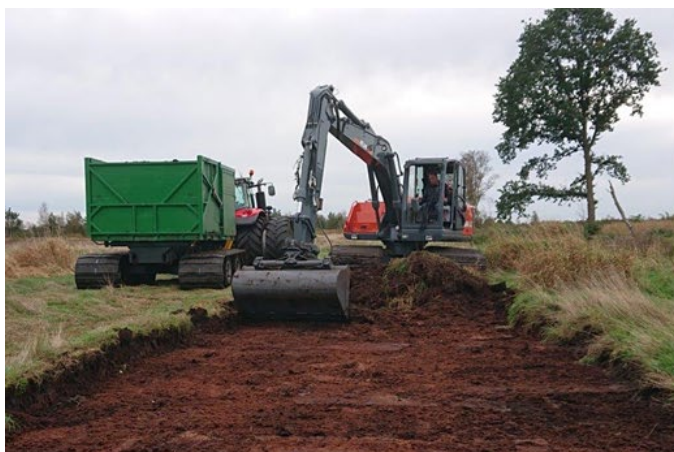
Abb. 10: Beispiele für Moorraupen und Moorbagger mit sehr breiten Laufwerken. Im linken Bild ist zudem eine Doppelbereifung zu sehen (Fotos: Graf, LBEG / Stadtmann, LBEG).
