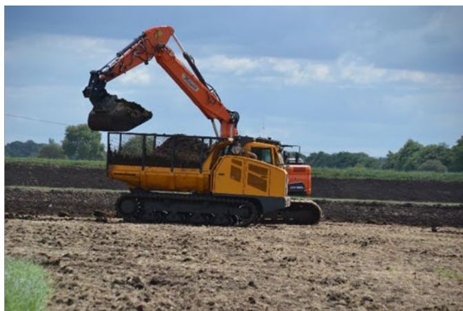
Abb. 10: Beispiele für Moorraupen und Moorbagger mit sehr breiten Laufwerken. Im linken Bild ist zudem eine Doppelbereifung zu sehen (Fotos: Graf, LBEG / Stadtmann, LBEG).
