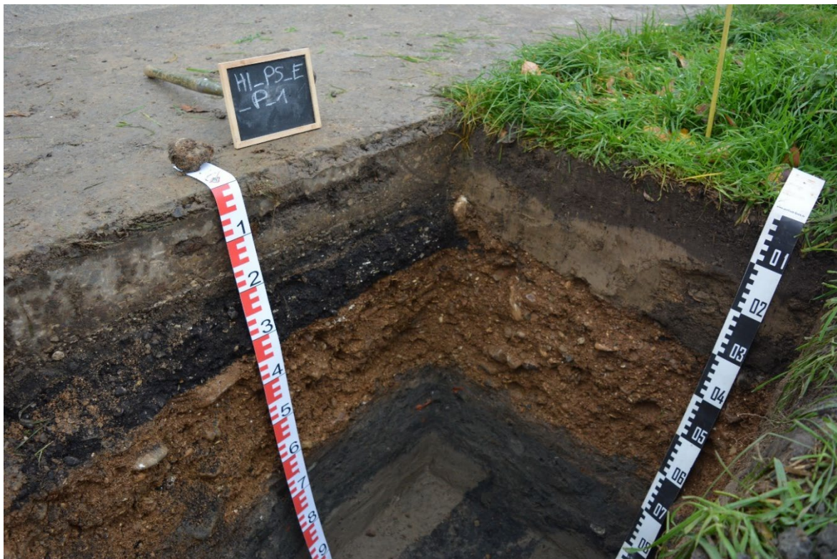
Abb. 33: Profilgrube im Bereich der zurückgebauten Panzerstraße (Bildrechte: LBEG). In der linken Bildhälfte ist der vollversiegelte Ausgangszustand zu erkennen. Im Zuge der Entsiegelung wurden halbseitig die Betonplatten sowie die gebundene Tragschicht entfernt und die oberen 30 cm anschließend mit sandigem bzw. schluffig-tonigem Bodenmaterial aufgefüllt.
