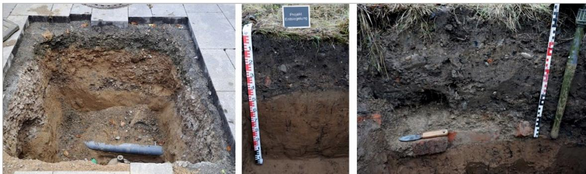
Abb. 8: Beispiele für urbane Böden mit anthropogenen Beimengungen und technogenen Substraten (Bildrechte: LBEG).
