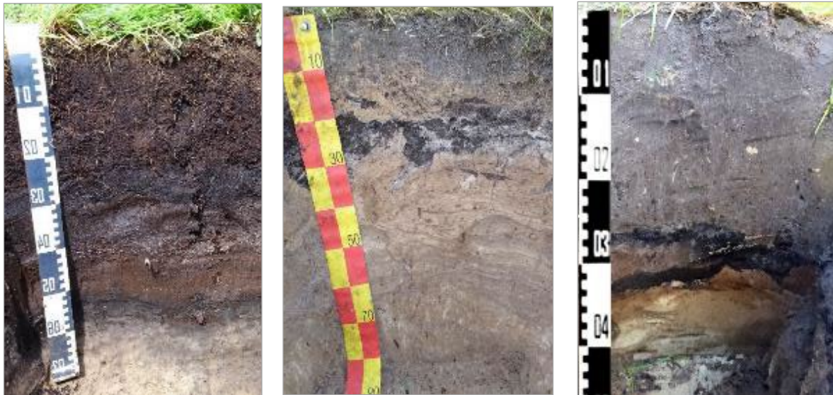
Abb. 5: Unvollständige Abtorfung (A) und Fehnkulturböden (B und C) in den Kolonaten der Fehnkultur.
