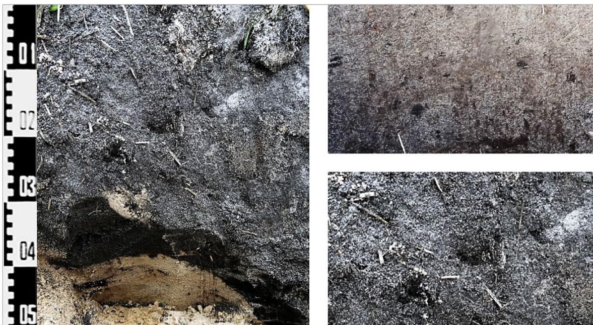
Abb. 22: Beispiel eines umgebrochenen Gleys mit ehemaliger Erdniedermoorauflage und Torfresten im Pflughorizont.
