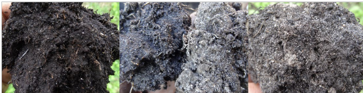
Abb. 26: Unterscheidung des Kohlenstoffgehalts bei stark zersetzten, umgebrochenen Torfen. Links: C_{org} > 15\% – die Sandkörner „schwimmen“ in einer Matrix von stark zersetztem Torf. Rechts: Sandkörner liegen häufig nebeneinander – Kohlenstoffgehalt 5–15 % (nicht schätzbar). Mitte: beide Varianten nebeneinander zum Vergleich.
