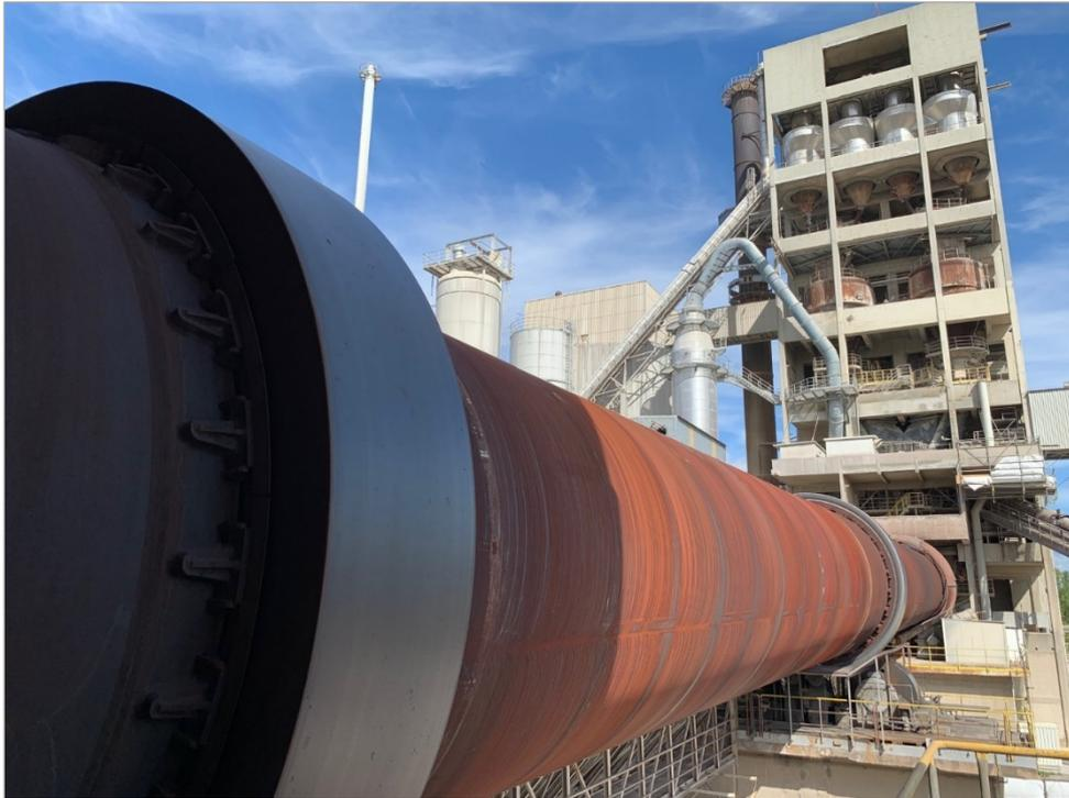
Abb. 5.4.4: Im Drehrohrofen wird das feine Rohmehl (Kalkmergel und Zuschlagsstoffe) bis zu 1450 °C erhitzt. Infolge einer chemischen Umwandlung bildet sich Zementklinker.
