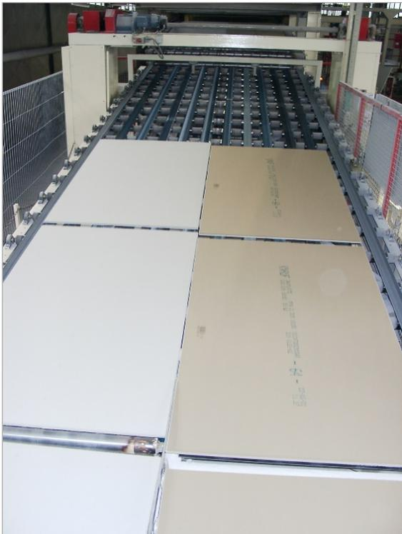
Abb. 5.5.4: Produktion von Gipskartonplatten.
