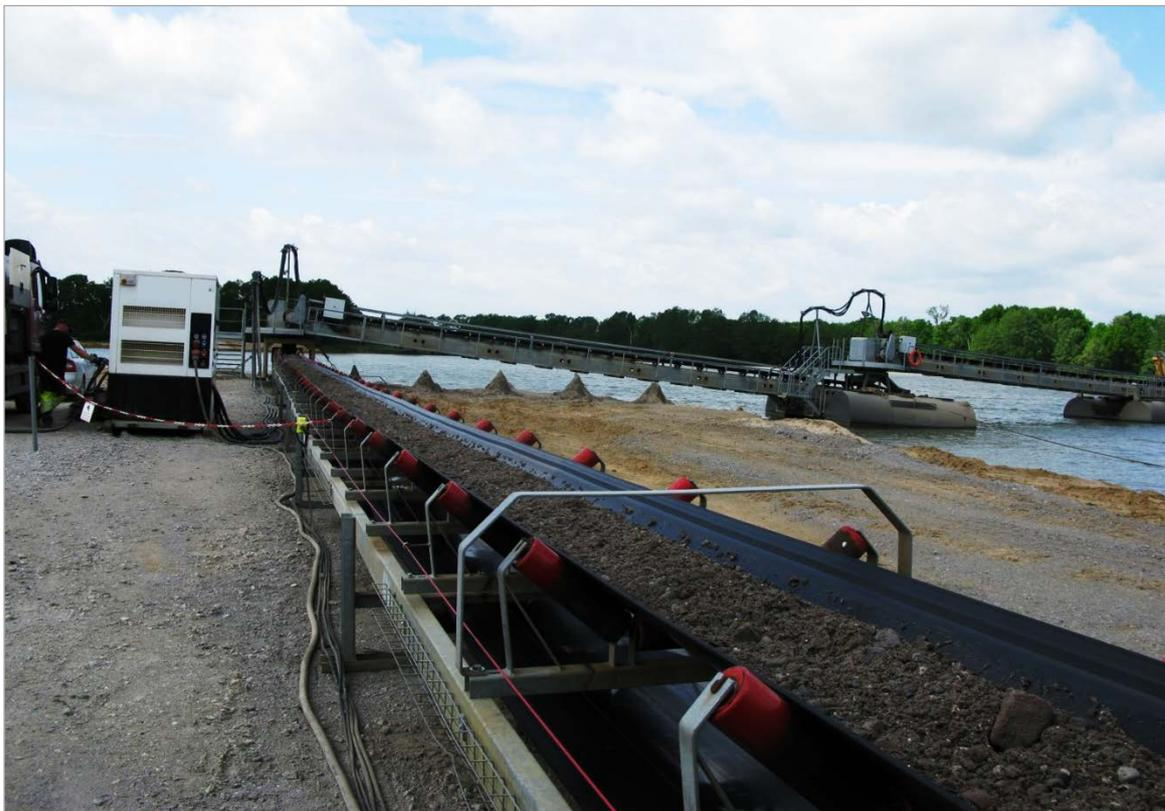
Abb. 5.1.7: Transport von Kies aus dem Nassabbau zur weiteren Aufbereitung und Sortierung, Region Hannover.
