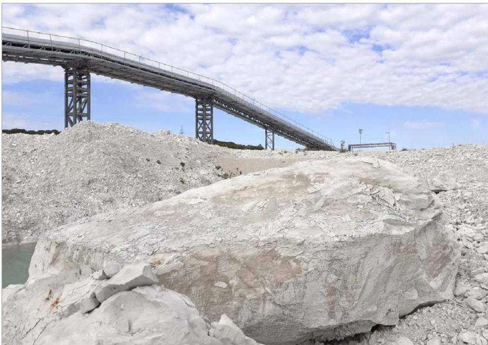
Abb. 5.4.2: Kalkmergelsteinabbau der Oberkreide in der Region Hannover. Der Kalkmergelschotter wird über Förderbänder zur Materialaufbereitung transportiert.
