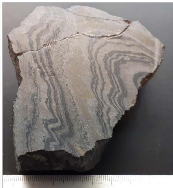
Abb. 3.3.2.: Melierterz aus dem Erzbergwerk Rammelsberg bei Goslar.
