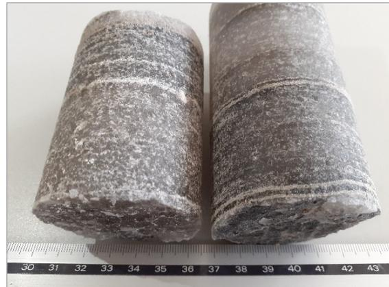
Abb. 3.2.2: Bohrkern aus dem Hauptsalz der Staßfurt-Formation.
