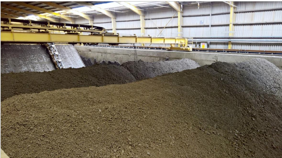
Abb. 5.2.6: Lagerung und Aufbereitung, hier Mischung unterschiedlicher Zusammensetzungen und Qualitäten, von Lauenburger Ton zwecks Homogenisierung mittels Quersumpfanlage.
