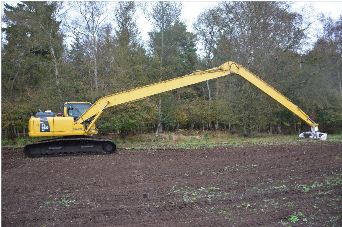
Abb. 5.9.3: Bagger mit extra langem Ausleger und Mähkorb mit Doppelmessermähwerk zur Ernte von Torfmoosen von der Verwallung aus.
