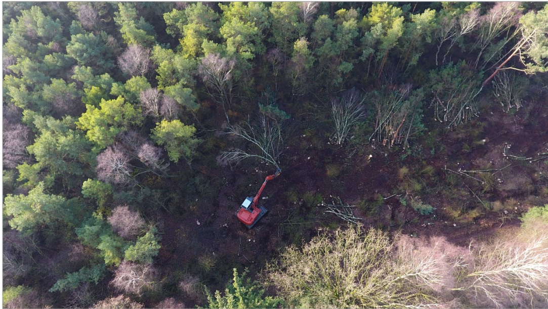
Abb. 8.3: Moorbagger mit hydraulischer Baumschere (Lichtenmoor, LK Nienburg/Weser, 2019; Foto: T. Beuster).
