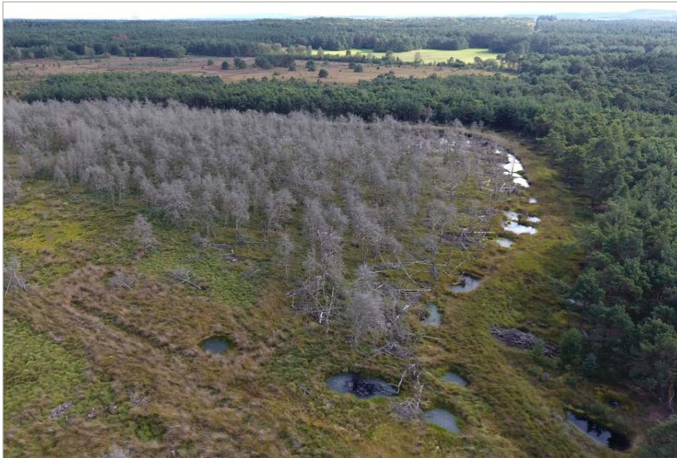
Abb. 4.7: Verwallung 7 Jahre nach Bau; die Bäume sterben im Einstaubereich deutlich ab, und die Torfmoose wachsen auf (NSG Rehburger Moore, LK Nienburg/Weser, 2020). Durch zu schmale Freistellung der Arbeitsgasse erfolgte die Torfentnahme dicht an der Verwallung (Foto: T. Beuster).
