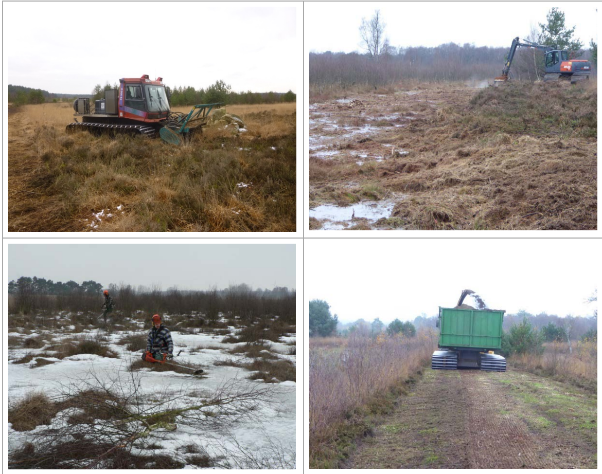
Abb. 9.1: Oben links: Pflegemaßnahme durch Moorraupe mit Mulcher auf Anmoorheide (NSG Heilsmoor, LK Osterholz; Foto: H-G. Kulp). Oben rechts: Forstmulcher am Bagger auf Moorlaufwerk mulcht Gehölze auf Heidemoordamm und im vor gut 20 Jahren wiedervernässten bäuerlichen Handtorfstich, soweit der Baggerarm reicht. Der erzeugte minimale Birkenstockausschlag spricht für nachhaltige Wirkung in den Folgejahren (NSG Rehdener Geestmoor, 11.12.2015; Foto: F. Niemeyer). Unten links: Im vor gut 20 Jahren wiedervernässten Handtorfstich mit Schwingrasen werden Jungbirken mit Freischneidern entfernt, Durchführung begünstigt durch eine hinreichende Eisbildung (NSG Oppenweher Moor, 09.02.2010; Foto: F. Niemeyer). Unten rechts: Mulchen mit Abfahren im Pistenbulli mit Kübel von verbirkender Besenheide auf Torfdamm zwischen wiedervernässten Handtorfstichen. Die vor vielen Jahren abgeschrägten, inzwischen verbirkten Torfstichkanten wurden anschließend mit Forstmulcher am Bagger forstgemulcht (NSG Rehdener Geestmoor, 03.11.2016; Foto: F. Niemeyer).
