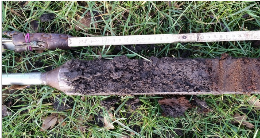
Abb. 6.3: Landwirtschaftlicher Oberboden im Bohrstock mit 23 cm Mächtigkeit, darunter Weißtorf (Foto: Hofer & Pautz GbR).
