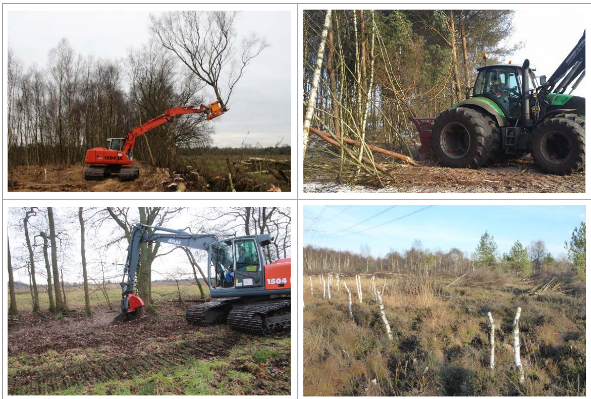
Abb. 4.1: Oben links: Moorbagger mit hydraulischer Baumschere (Lichtenmoor, LK Nienburg/Weser, 2020; Foto: T. Beuster). Oben rechts: Trecker mit Forstmulcher, durch zweimaliges Überfahren werden die Bäume komplett zerkleinert und die Stubben bodeneben abgefräst (NSG Holtorfer Moor, LK Nienburg/Weser, 2010; Foto: T. Beuster). Unten links: Moorbagger mit Tellerrad zum Stubbenfräsen, geeignet für dickere Bäume, die vorher abgekniffen wurden (Lichtenmoor, LK Nienburg/Weser, 2021; Foto: T. Beuster). Unten rechts: Entkusselung von Moorbirke durch Schnitt in einem Meter Höhe und Spaltung des Stammes (NSG Borner Moor, LK Cuxhaven; Foto: L. Kulp).
