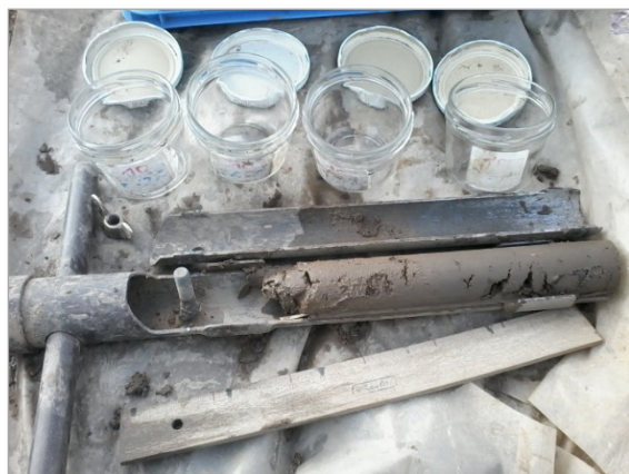
Abb. 11.3: Bodenstecher zur Entnahme der Kleinringelwurmproben auf Acker.
