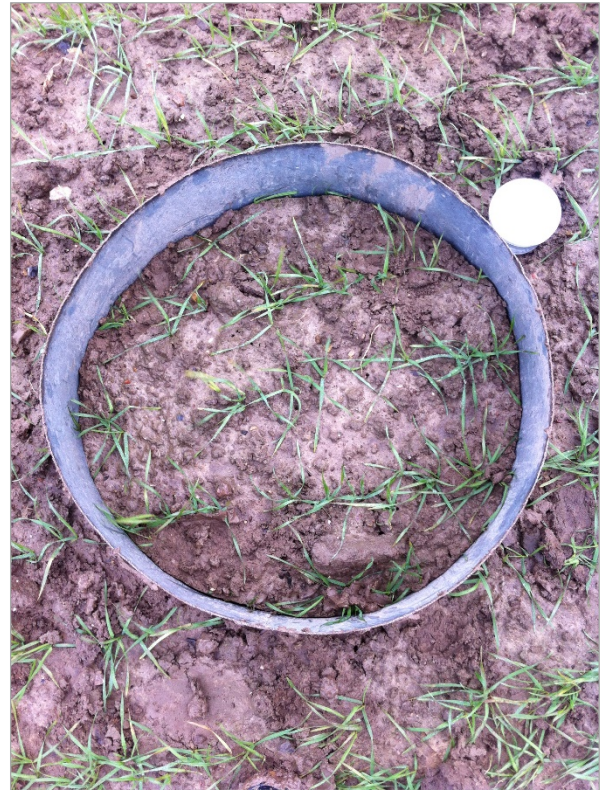
Abb. 11.2: Metallring zur Formalinextraktion insbesondere tiefgrabender Regenwürmer.
