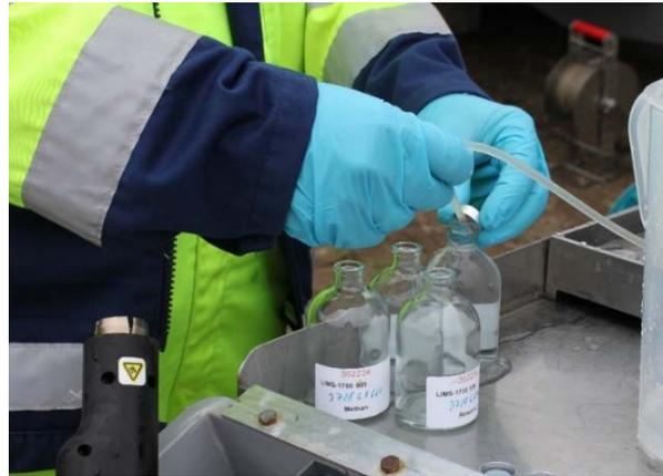
Abb. 7: a) Grundwasserprobenahme mittels Tauchmotorpumpe MP1 (Foto: Roskam, NLWKN), b) Grundwasserentnahme zur Gas- und Isotopenanalyse durch einen LBEG-Mitarbeiter.
