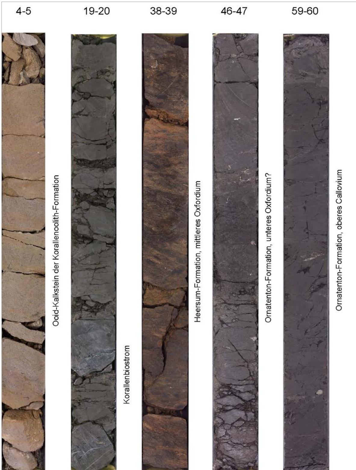
Abb. 25: Auswahl von Bohrkernen der Kernbohrung Wendhausen 6 (Korallenoolith- bis Ornatenton-Formation); die Länge des Bohrkerns entspricht 1 m.
