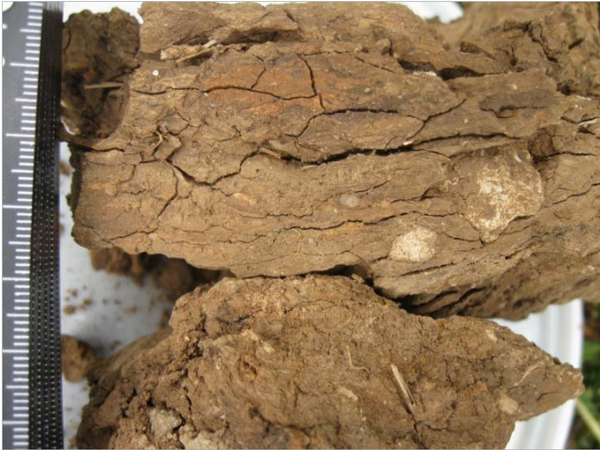
Abb. 13: Plattengefüge als Indikator schwerer Strukturschäden durch Bodenverdichtung (Foto: J. Zausig, GeoTeam GmbH 2014).
