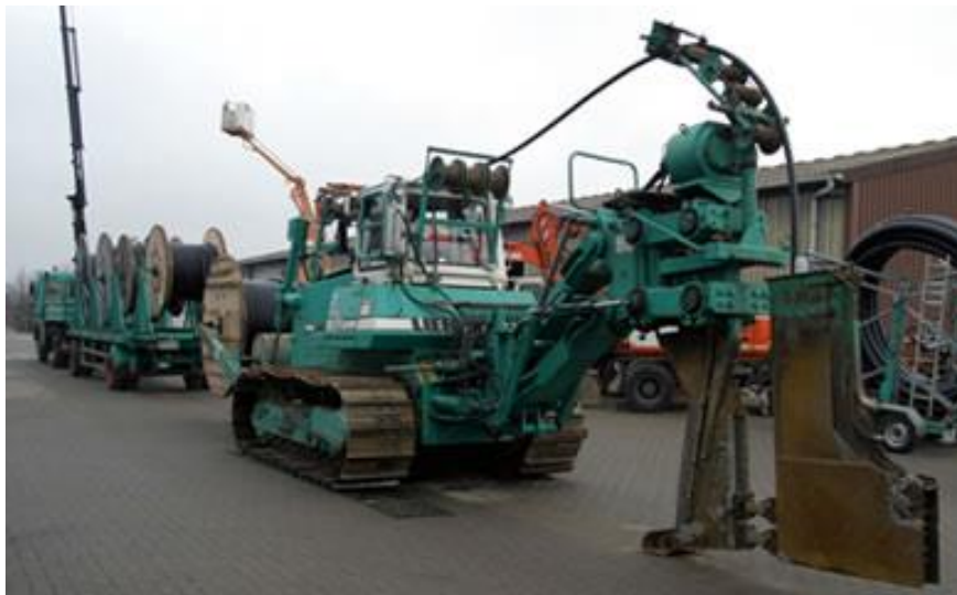
Abb. 19: Beispiel Kabelpflug (Quelle: www.heinz-bente.de )
