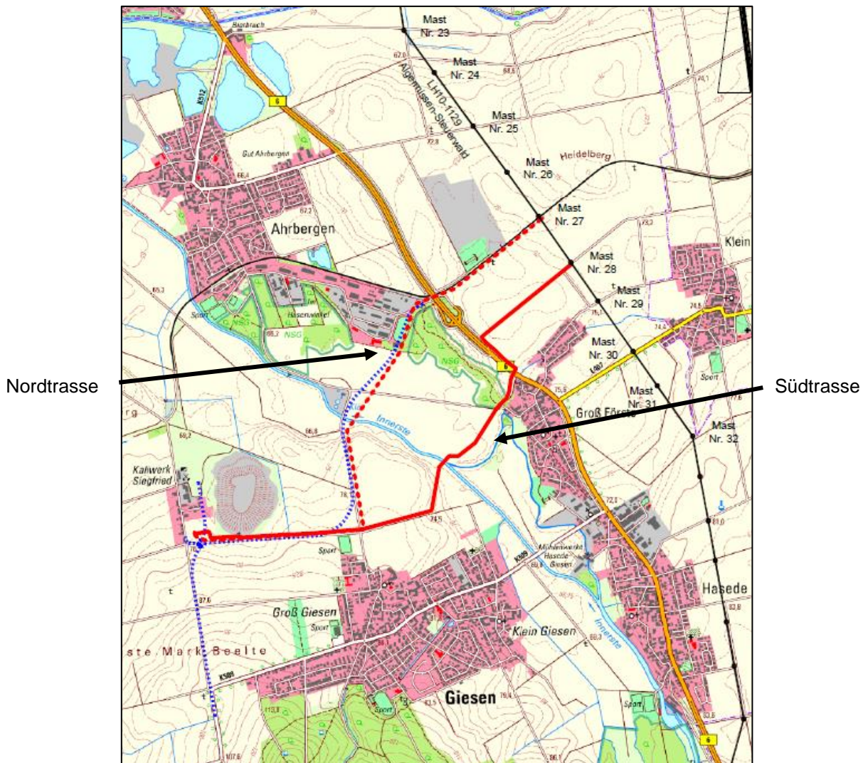
Abb. 10: 110 kV-Trassenvarianten – Nord- und Südkorridor
