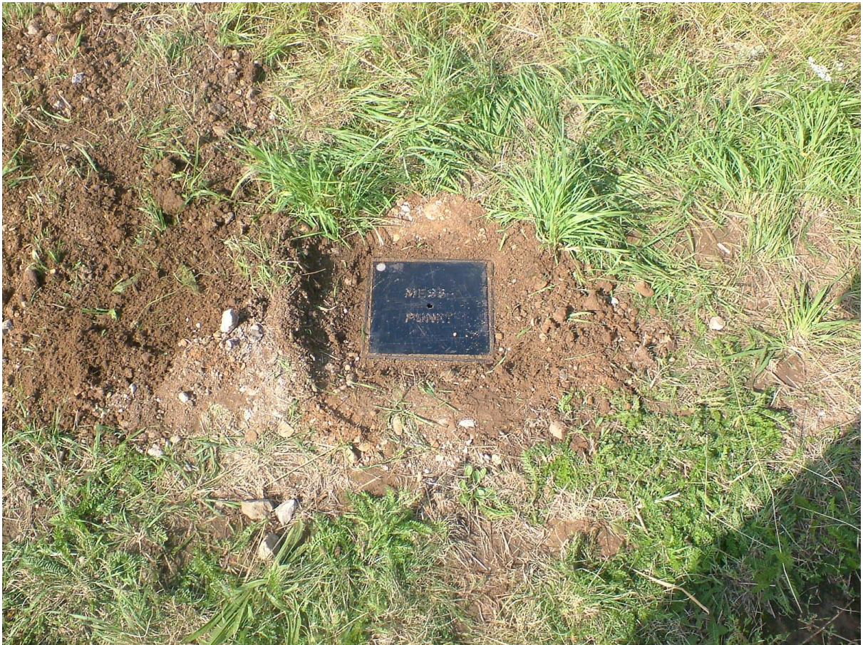
Abb. 2 Pfeiler mit Schutzdeckel am Wegrand
