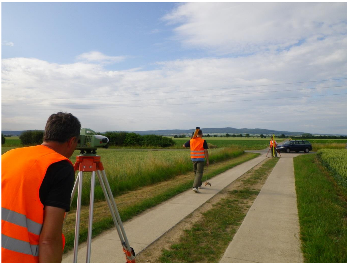
Abb. 4 Messtrupp mit digitalem Nivelliergerät (im Vordergrund) und 2 Messlatten
