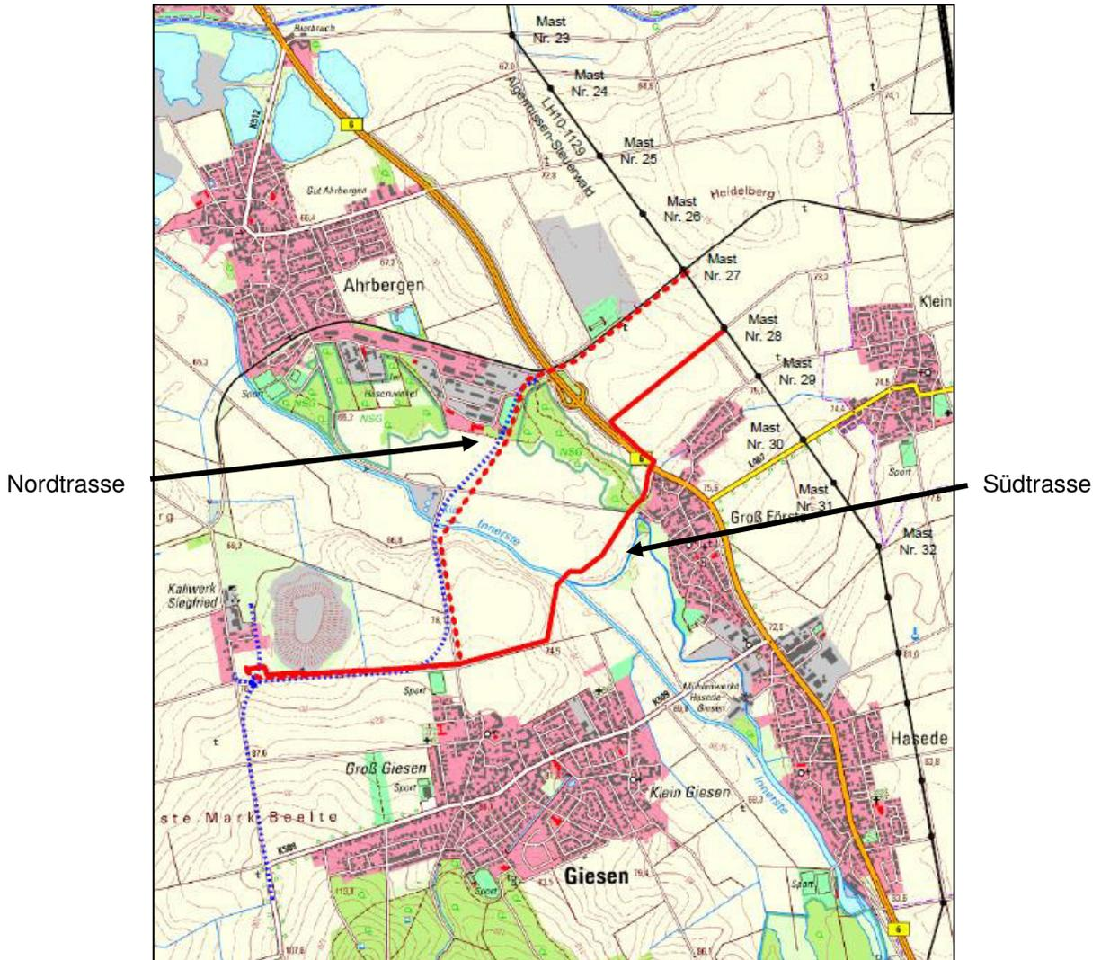
Abb. 10: 110 kV-Trassenvarianten – Nord- und Südkorridor
