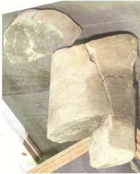
Abbildung 3: Schemazeichnung eines Petal-Centerline-Fractures nach Evans (1980) und Beispiel einer Bohrung aus einem Ölfeld in Norddeutschland aus einer Tiefe von 492 m.
